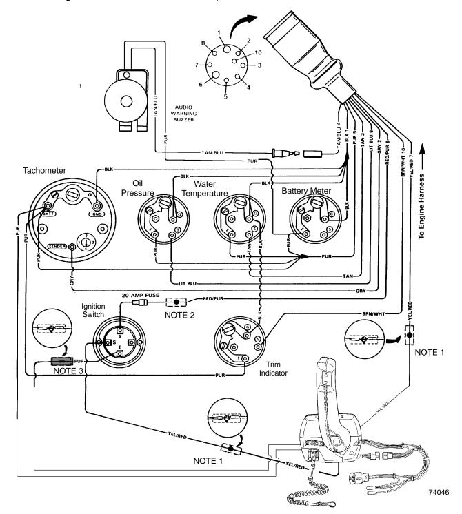
BREAKER POINT IGNITION - DUAL STATION USING A NEUTRAL SAFETY SWITCH IN ONLY ONE REMOTE CONTROL
